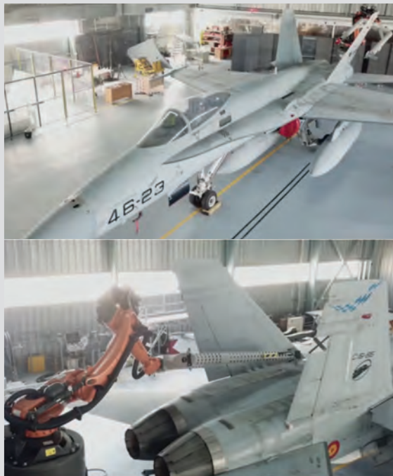
Figura 1. Sistema robótico de inspección por radiografía digital de seis ejes
