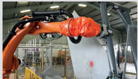
Figura 3. Configuración del robot de ultrasonidos para superficies de mando
