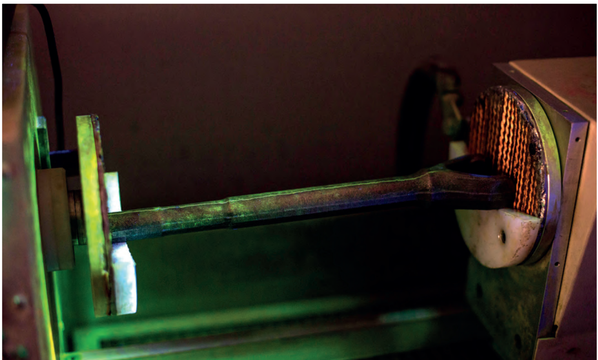
Inspección mediante partículas magnéticas fluorescentes
