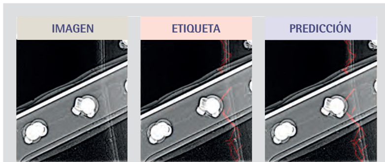
Figura 14. Resultado de la detección de la IA de radiografía digital con IMA-GIA sobre una estructura mixta de aluminio y fibra de carbono en una deriva vertical con indicaciones en un sellado externo deteriorado que interfiere en las zonas de inspección
