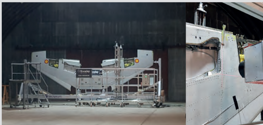
Figura 2. Sistema robótico de inspección por radiografía digital de cuatro ejes
